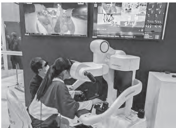
図3 国産手術支援ロボット hinotori の遠隔操作デモ (日本電信電話株式会社)
