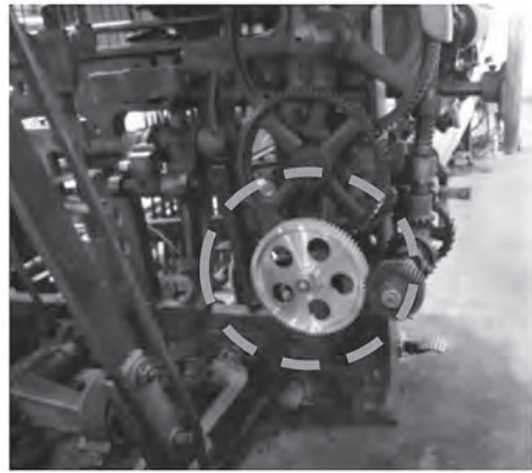
図8 シャトル織機に組み込んだ歯車
