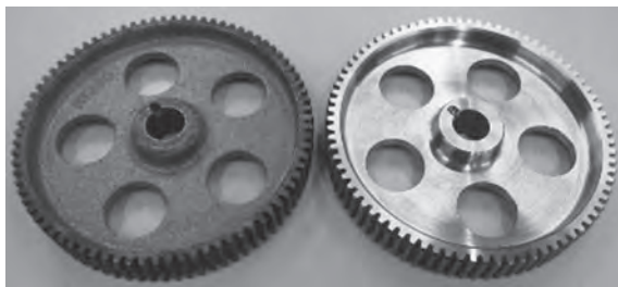
(左)従来部品 (右)再生部品 図7 再生した歯車
