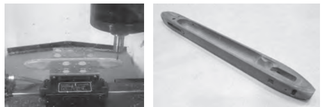
(作製の様子) (完成品) 図9 再生したシャトル
