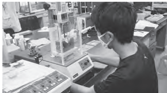
写真5 材料の弾性力を感じながらの曲げ試験
