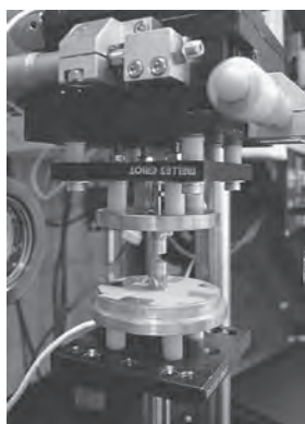
図1 電場を用いて微粒子や液滴を空中に浮遊できる電気力学天秤 (EDB)
