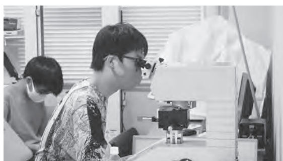
写真4 ビッカース硬度試験機による硬度測定
