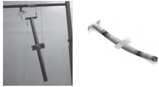
図9 被試験体のハンマリング試験とCAE解析の様子
