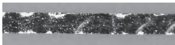
図1 スリット糸 (アルミ蒸着シルバーラメ) 【幅: 80切 (約0.38mm)、厚さ: 12 μm】
