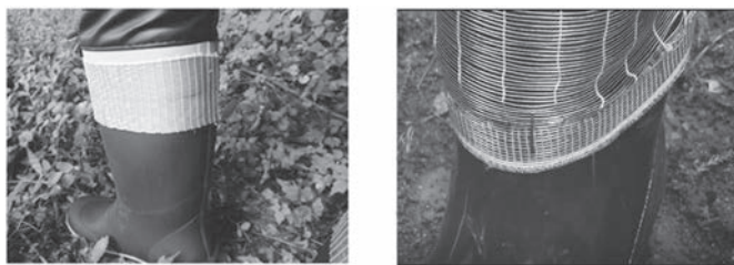
図3 長靴に装着した試作銅レース編地 (右: 試作銅レース編地に触れて動きを止めたヤマビル)
