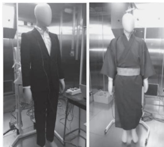
図1 サーマルマネキン実験の着用状況
