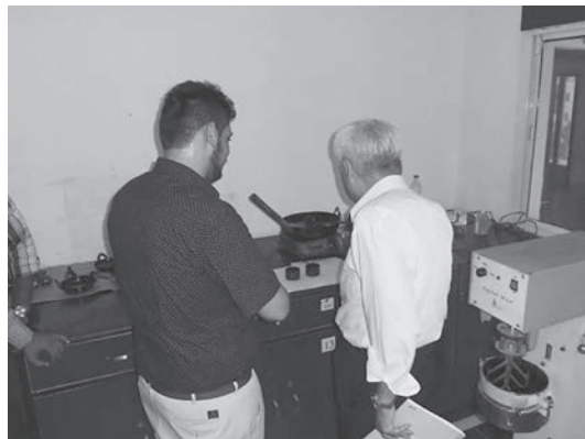
アスファルトを加熱しているところ。 シース熱電対で温度を測定していた。
