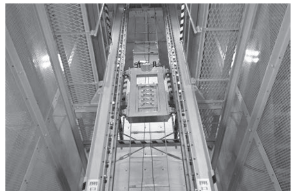
写真2 登山用ロープ落下衝撃試験施設
