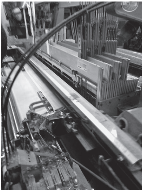
写真17 肉厚の箆を固定出来る様に改造
