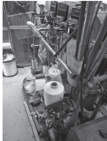
写真19 ヨコ糸金属線供給部分の様子
