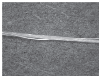
写真1 ステンレス \phi 0.05mm/ ソルブロン100D 撚数 390T/m
