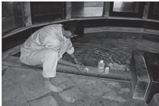
図4 浴槽の温泉をサンプリングして細菌検査を実施
