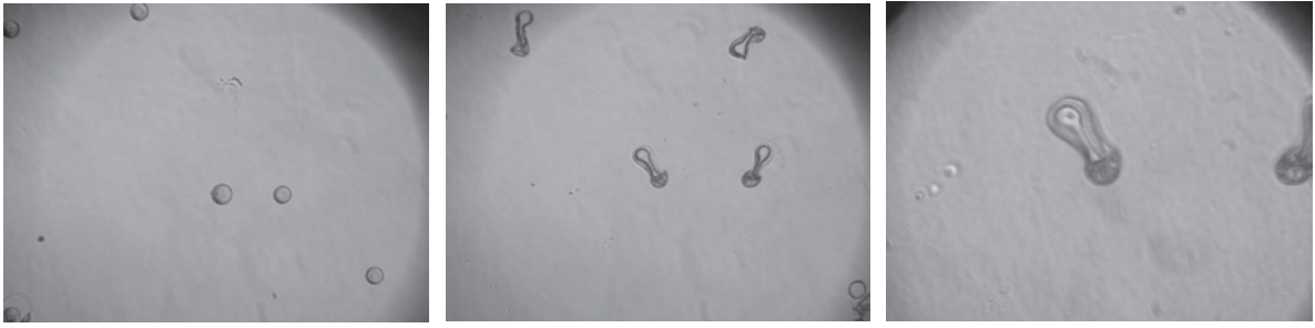
図3 花粉アレルゲンを不活性化しアレルギー反応を緩和する様子を捉えた光学電子顕微鏡の画像 ＊複合イオン水溶液に花粉が付着して膨張したあと破裂しひょうたん型に収縮してアレルギー反応を不活性化の様子が撮影されている
