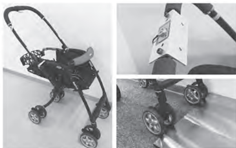
図2 実機を用いた走行実験
