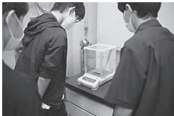
アルキメデス法で発泡アルミニウムの密度算出
