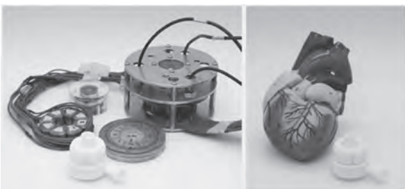
開発中の小児用人工心臓の試作機(手前)と、研究室製作の人工心臓のプロトタイプ = 群馬大学提供
