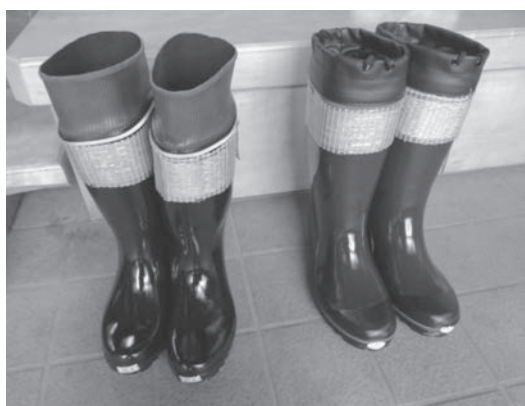
図5 金属レース地を装着した長靴
