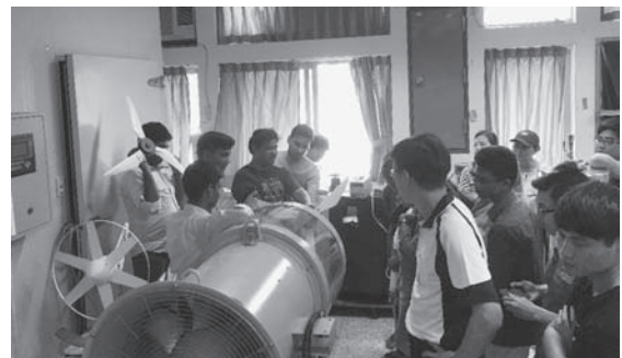
図2 風力発電機の効率試験の様子
